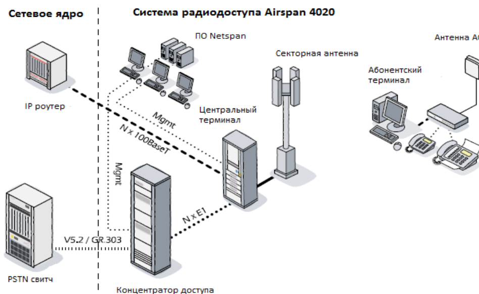
Рис.1. Архитектура системы Airspan 4020
